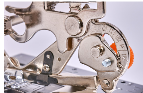
Réglage de la Profondeur réglé à 8.
