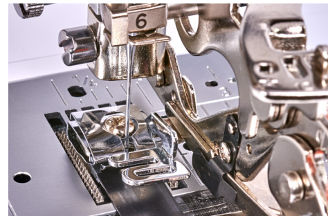
Position de l'Aiguille Centrale sur le pied à Plisseur.
